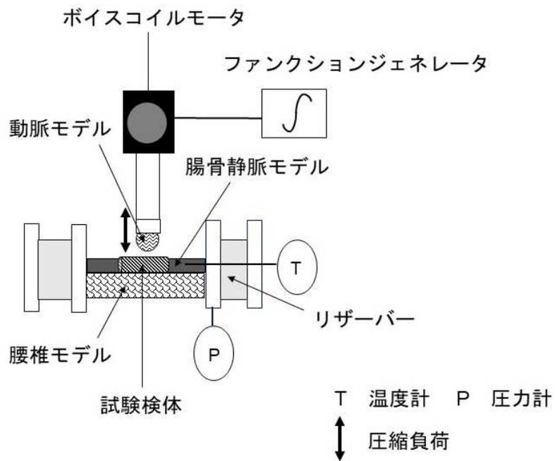
図 1 試験装置 構成例
